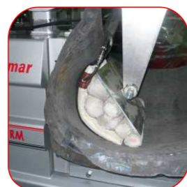
Système de pression au moyen de sac et de plaque d'appui.
