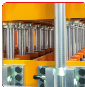
Druck durch Hydraulikkolben bis zu 14 Bar.
