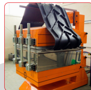
Konzipiert für die Herstellung von Gummiteilen und zum Vulkanisieren von Profilen und Guminoppen / Stollen.
