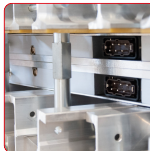
Versenkte Elektro- und Kühlanschlüsse.
