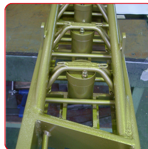
Gleichmäßiger Druck durch Hydraulikkolben.
